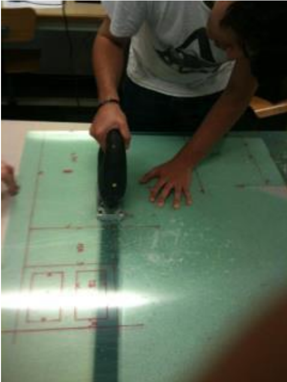
Phase de découpe du plexiglas constituant l'ossature de notre appareil.
