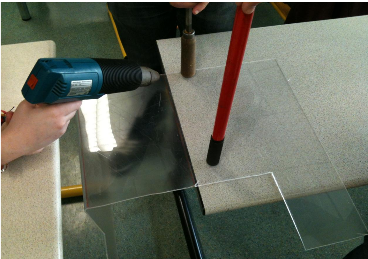
Pliage du plexiglas à l'aide d'un souffleur à air chaud.
