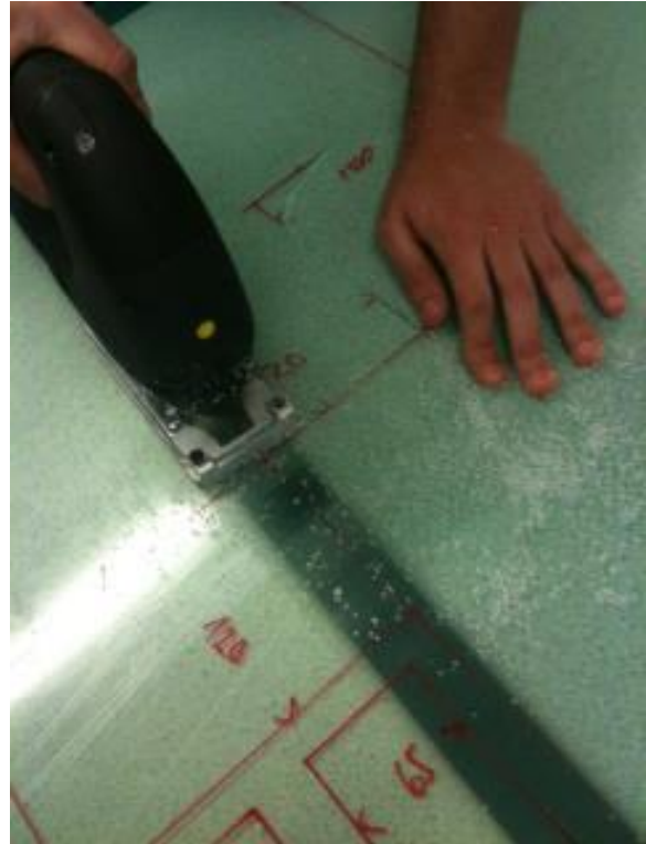
Phase de découpe du plexiglas constituant l'ossature de notre appareil.
