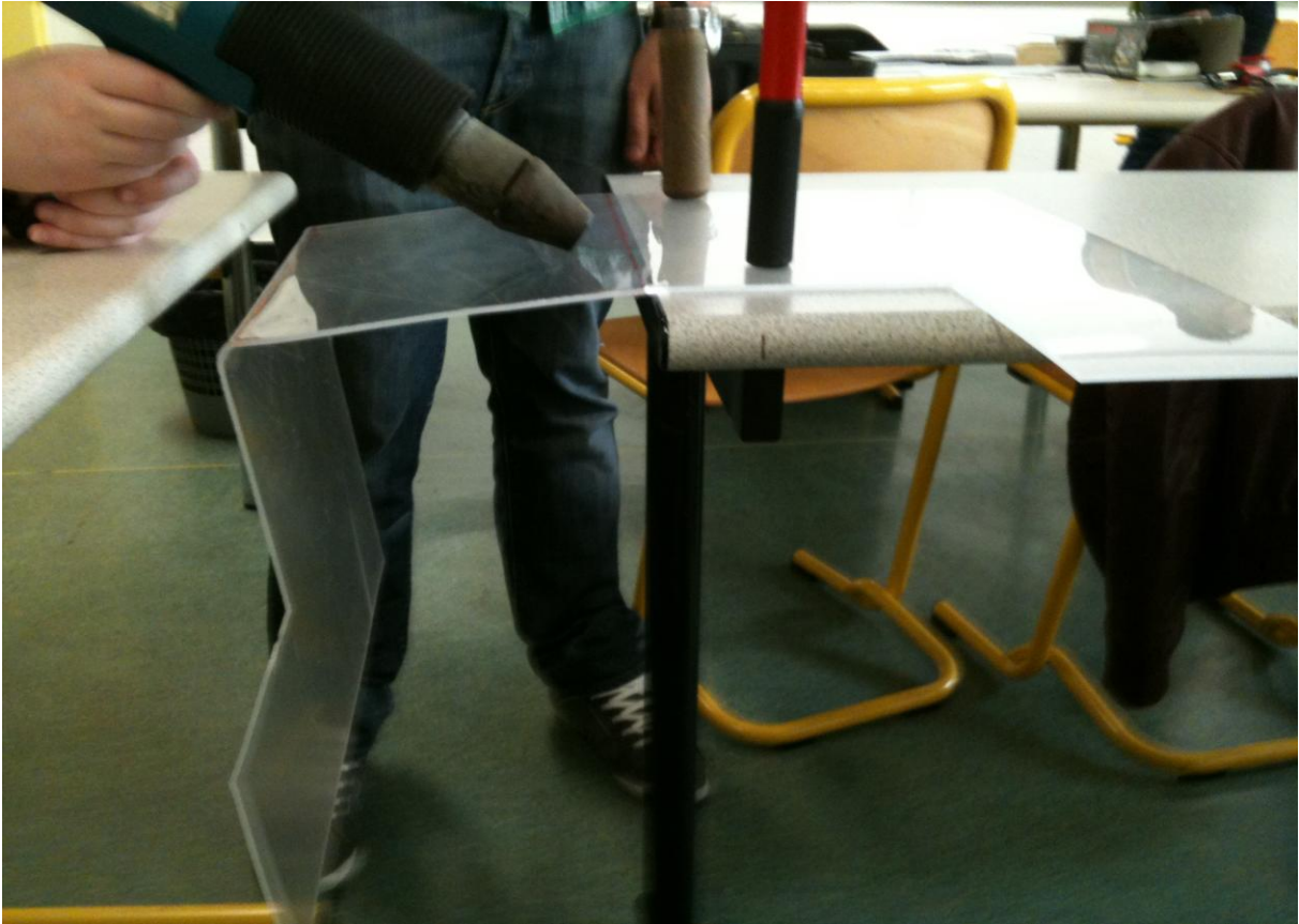
Opération de pliage après chauffage.
